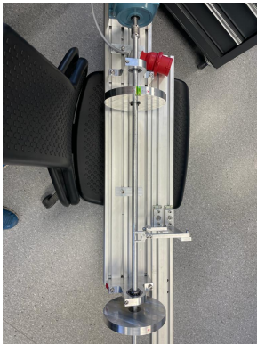
Abbildung 2. Realer Aufbau des Rotorprüfstands mit den beiden Schwungrädern, den beweglichen Sensorhalterungen rechts und dem Motor am oberen Ende der Abbildung.
